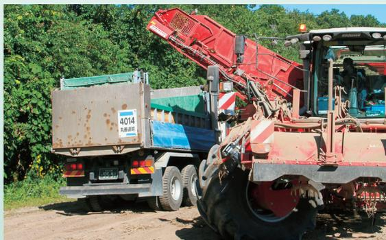
荷台の枠が下がった大型ダンプと収穫機バリトロン
