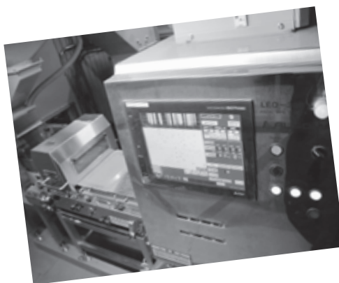
手選別を機械化した特徴認識選別機
