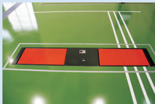
タイヤ(車輪)の整列度合を確認するサイドスリップテスター
