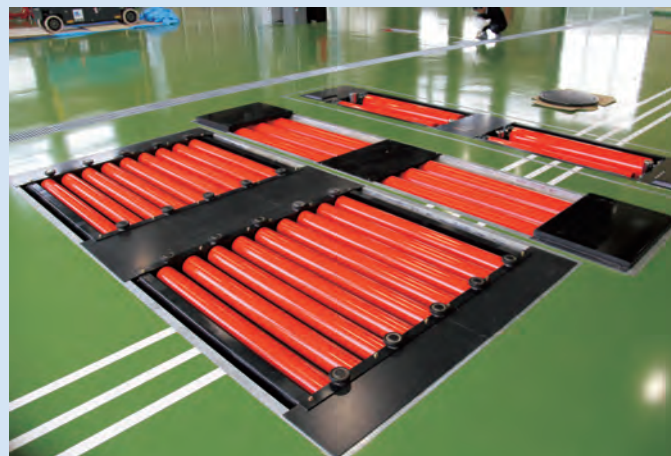
普通車、フルタイム4WD車はもちろん、 大型車も計測可能なプレーキテスター
