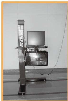
「ヘッドライトテスター」車両ライトの光度、光軸を計測します。
