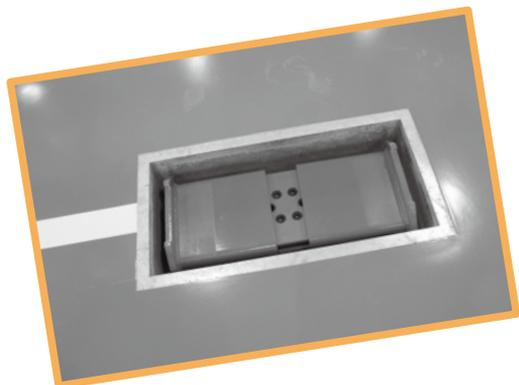
「大型トラックリフト」車両整備施設床埋設式で大型車両の点検が容易になります。
