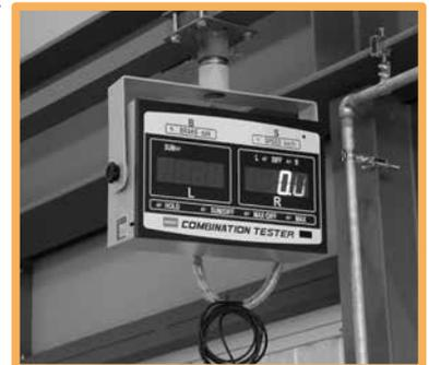
「ブレーキテスターモニター」ブレーキの制動力をデジタル表示します
